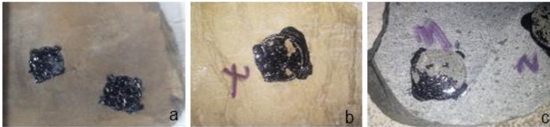
Figura 7. Comportamiento de la Unión Asfalto-Agregado en Condición Húmeda.
