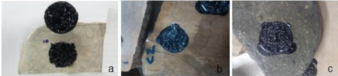
Figura 6. Comportamiento de la Unión Asfalto-Agregado en Condición Seca.
