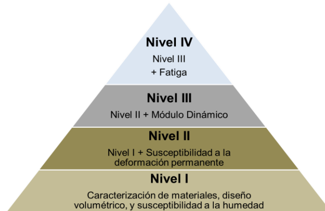
Figura 2 Criterio de selección de ensayos para la evaluación del diseño de mezcla asfáltica.
