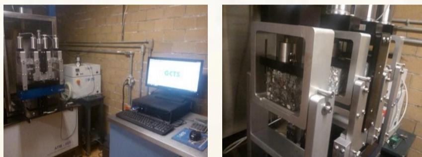
Apoyo en 4 puntos y distribución de carga
