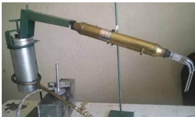
Figura 2. Izquierda, Obtención del residuo asfáltico por el método del sartén, aunque no es un método normalizado es bien sabido que es el más común para obtener residuo asfáltico. Derecha, Destilación de emulsiones por el método de alambique.
