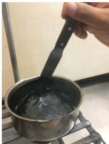
Figura 2. Izquierda, Obtención del residuo asfáltico por el método del sartén, aunque no es un método normalizado es bien sabido que es el más común para obtener residuo asfáltico. Derecha, Destilación de emulsiones por el método de alambique.
