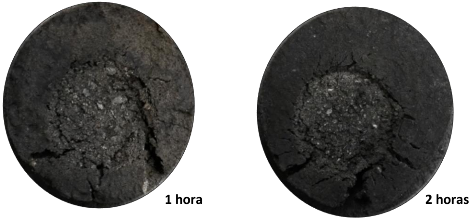
Figura 7. Apariencia de la cohesión de las mezclas, Emulsificante C / Emulsión 3
