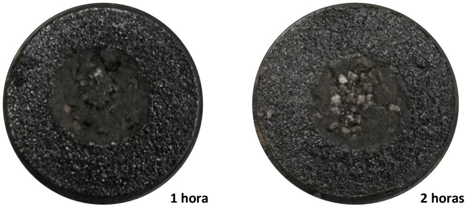
Figura 7. Apariencia de la cohesión de las mezclas, Emulsificante C / Emulsión 3
