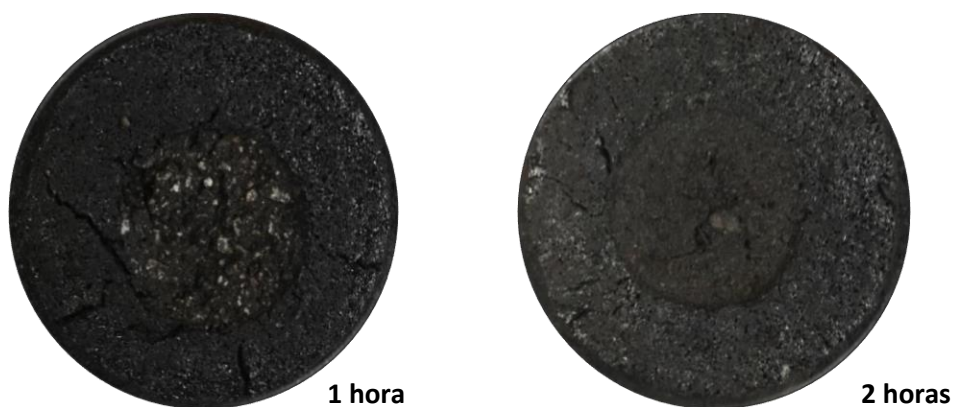
Figura 6. Apariencia de la cohesión de las mezclas, Emulsificante B / Emulsión 2
