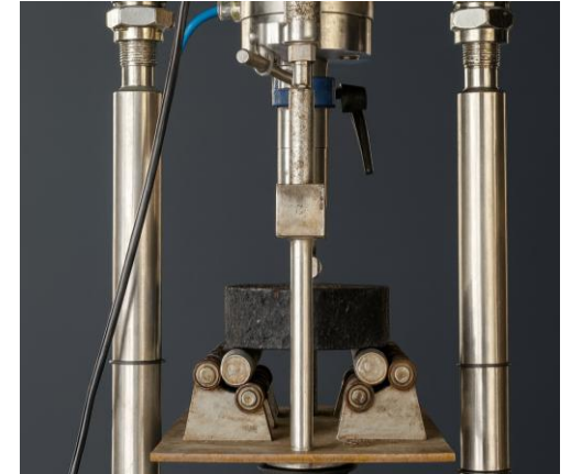
Ensayo de Flexión Circular
