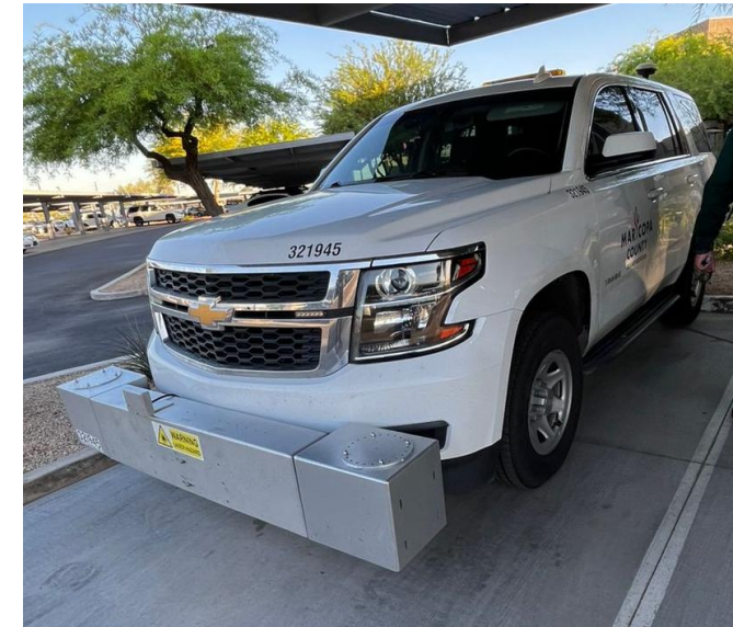
Figura 3. Perfilómetro Inercial Laser.
