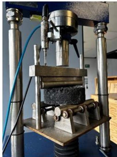
Ensayo EFC y curva carga-desplazamiento de la muestra 2725 V2-1
