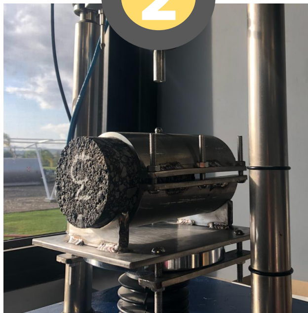
LCB ENSAYO DE ADHERENCIA ENTRE CAPAS
