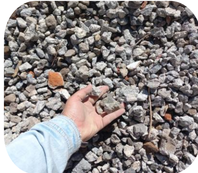
Agregado Procedente de RCD Fragmentos de concreto hidráulico triturado
