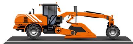
Fresado de las capas de firme a regenerar.
